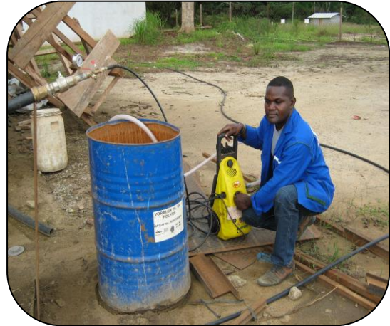
Essai de pression sur une conduite PEHD DN 63
